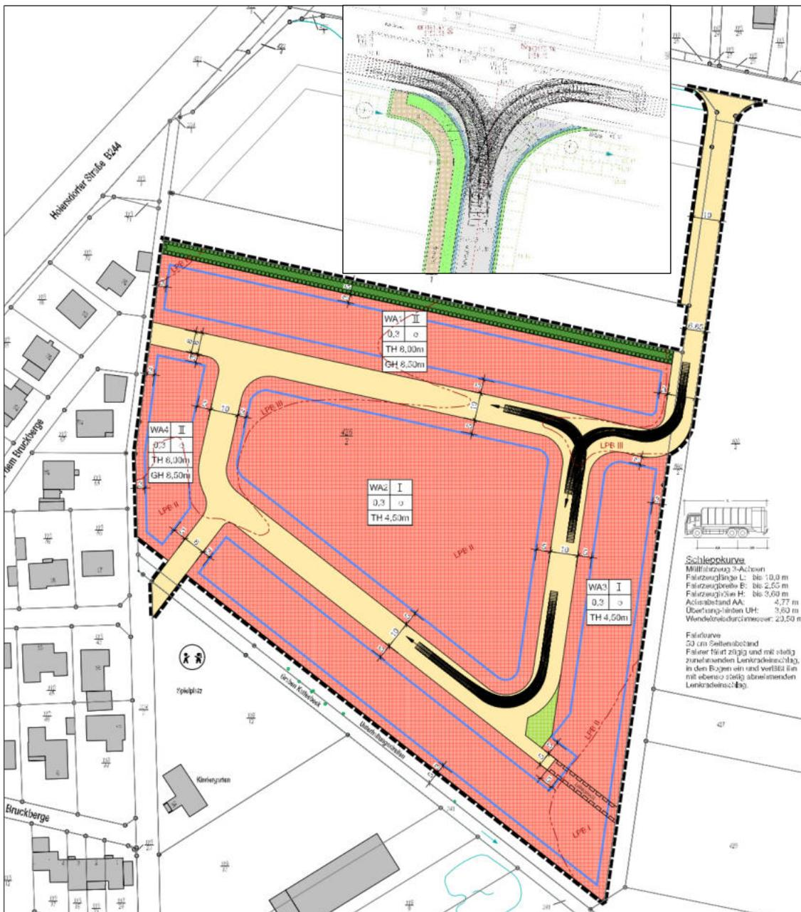
**Abb. 13:** Beispiel Schleppkurven für die Einmündung „Lange Trift“-Plangebiet und Straßenführung im Plangebiet für einen 3-Achser-LKW, ein Müllfahrzeug mit Nachläufer oder eine Feuerwehr mit 10 m Länge
